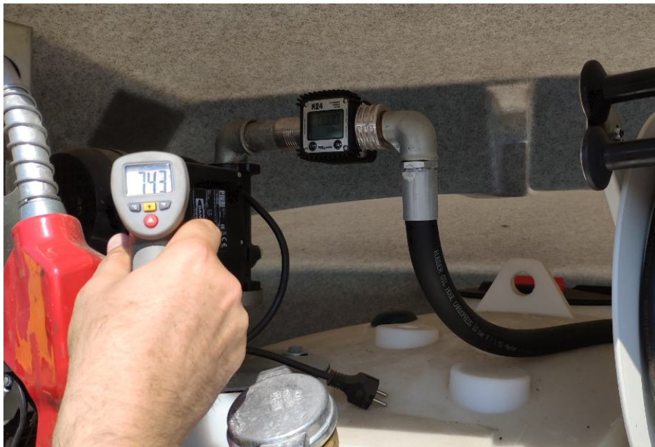
Rysunek 4. Pomiar temperatury wyrażony w °C przestrzeni międzyzbiornikowej w miejscu nasłonecznionym, w ciepłe dni.
